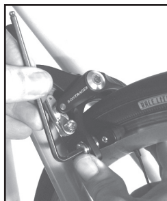
Figure 10 - Boulon de fixation du patin
